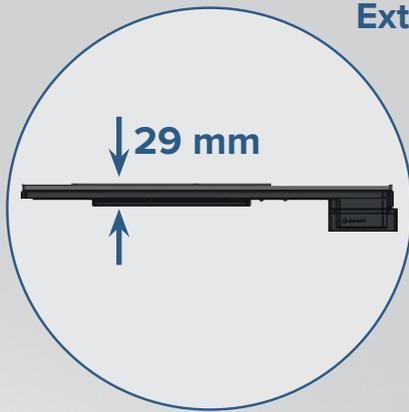
Durch die Nutzung von Linearmotoren und geschickt integrierten Komponenten lässt die extrem niedrige Bauhöhe wertvollen Freiraum oberhalb und unterhalb des Mikroskoptisches.
